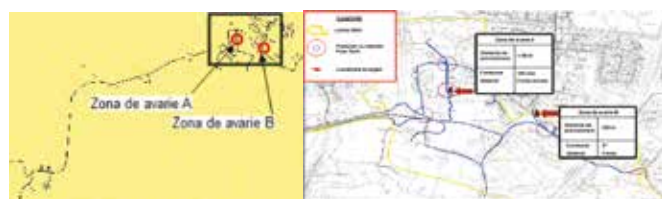
Fig. 3 [14] – (a) Identificarea zonelor cu pierderi de apă; (b) reprezentarea detaliată a zonelor reale de scurgere, comparativ cu rezultatele obținute prin metoda Posi-Tect (Sage și Croxton, 2005)
